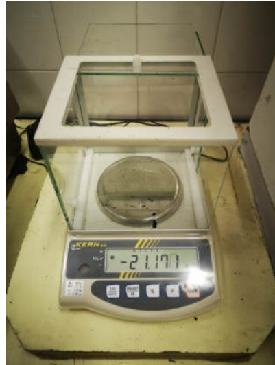
Mintatartó edény értékével tárazott mérleg
