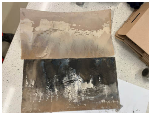
15. ábra A szűrőkre tapadt gumiörlemény részecskék
