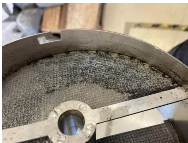
15. ábra A szűrőkre tapadt gumiörlemény részecskék
