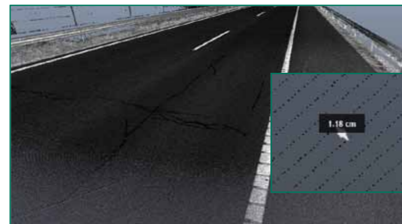
3. ábra Lézerszkennerral mért burkolat pontfelhője
