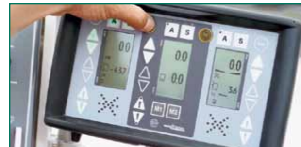
2. ábra Marógép vezérlő panelje, melyen a marási vastagságokat vagy az oldalesést lehet beállítani
