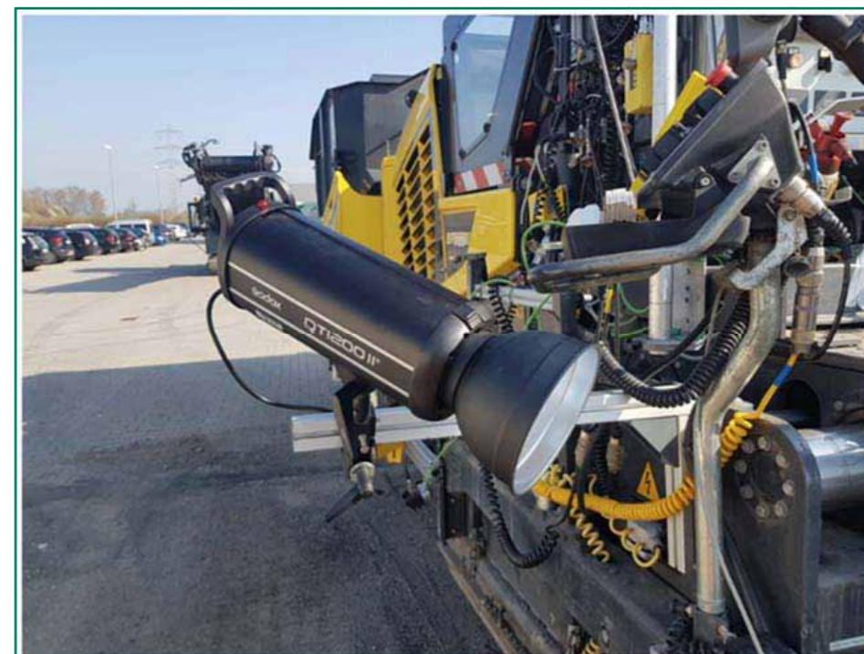
4. ábra: Helyszíni teszt – Kamera/vaku rendszer a finisherhez csatlakoztatva
