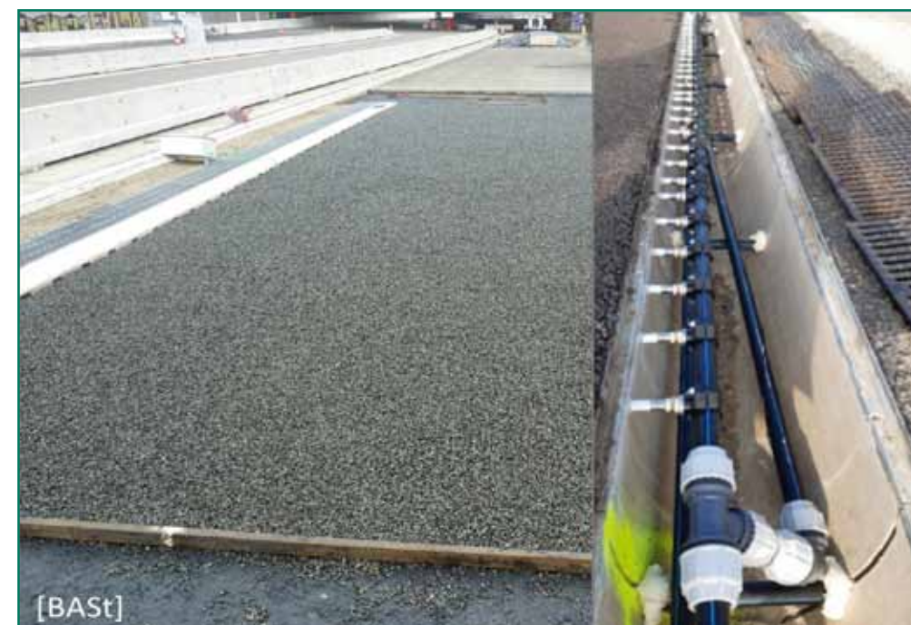
4. ábra: a poliuretán kötésű porózus közbenső réteg és a temperáló folyadék kivezető nyílásai
