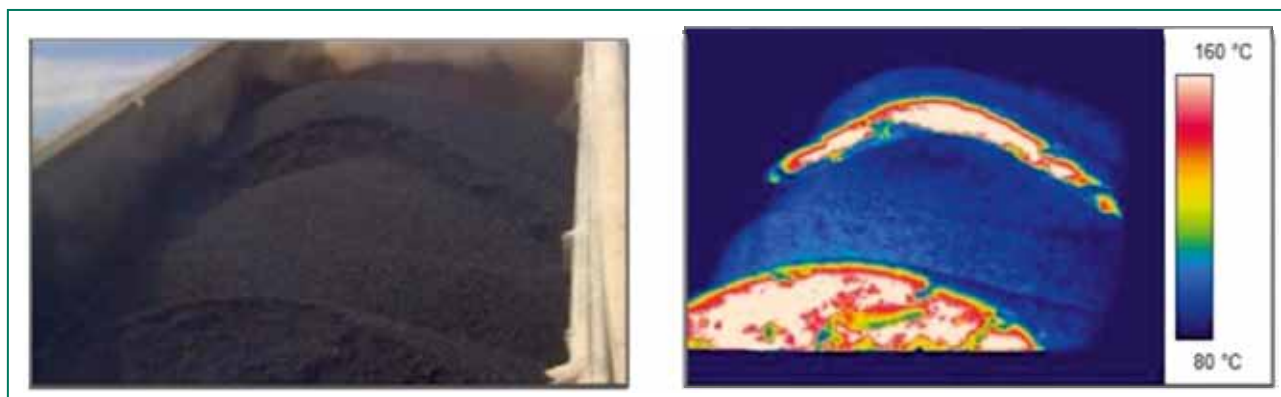
5. ábra: Aszfaltkeverék a kirakodás előtt (a) normál kép és (b) hőkép.
