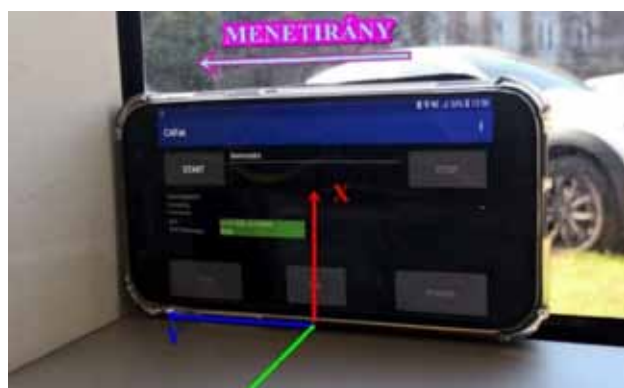
3. ábra: Alkalmazott mérési elrendezés a CAF villamos ablakának alsó sarkában (szilikonpaddal rögzítve)
