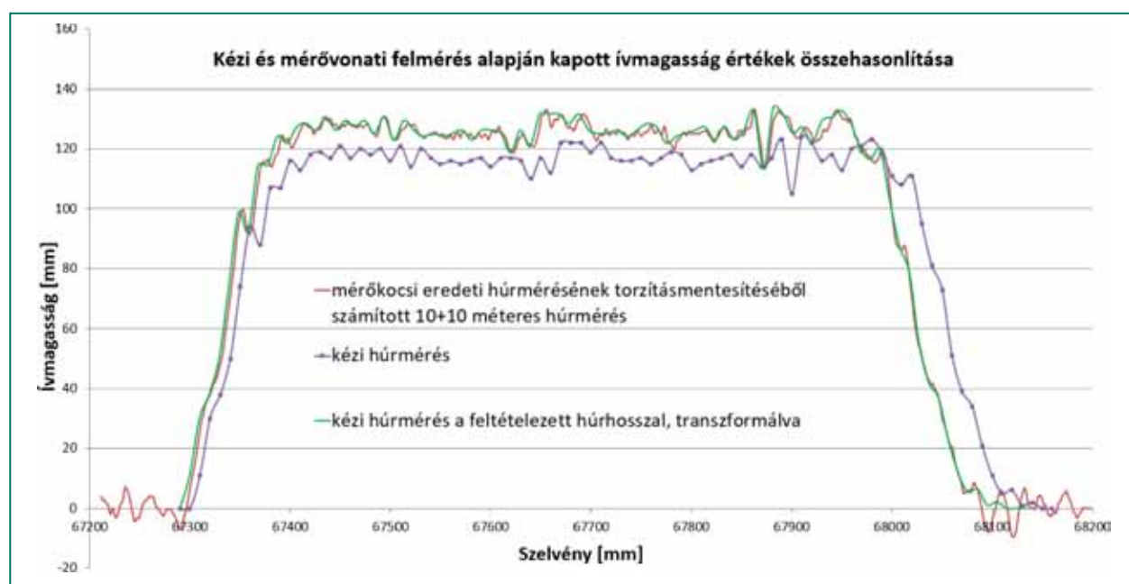
4. ábra Kézi és mérővonalati adatsorból számított ívmagasság értékek összehasonlítása
