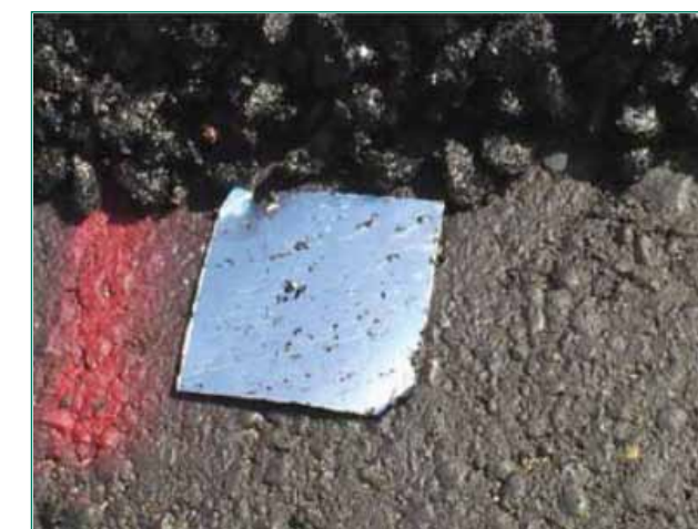
4. ábra. Rétegvastagság mérésnél az antipólus (Pethő és Tóth 2010)
