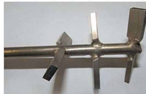
2. ábra: Lapátos keverő a rejuvenátor keveredéséhez
