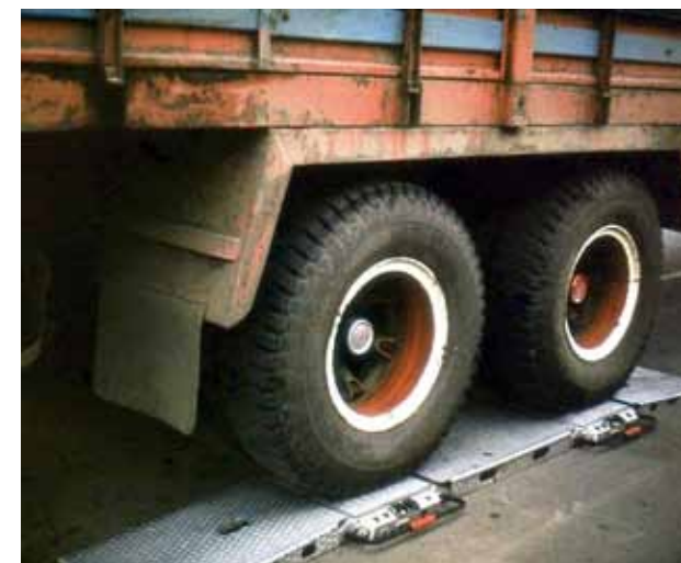
9-10. kép: Tengelyterhelés mérés Békés megyében. 1970-es évek végén. A mérés lassúsága miatt nem terjedt el.
