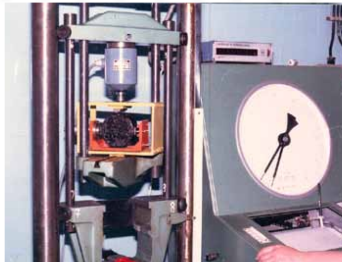
4. kép: Hasítás vizsgálat ZD-10 törőgépen
