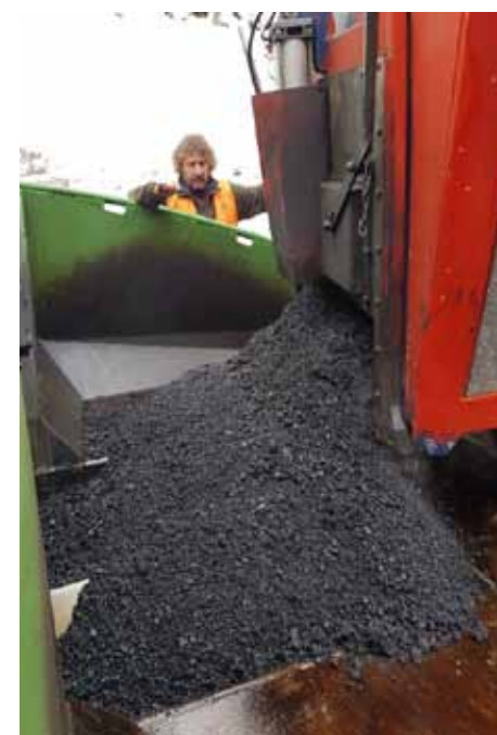
ACF22: 100% RAP + 4,5% REJUVENÁTOR a bitumenre vonatkoztatva
