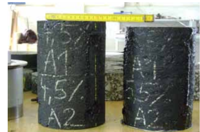
2. ábra: Deformált triaxiális minták [1]
