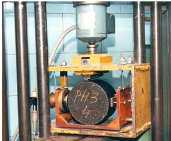
3. kép: Az oldalirányú alakváltozás mérését biztosító függesztett mérőkeret
