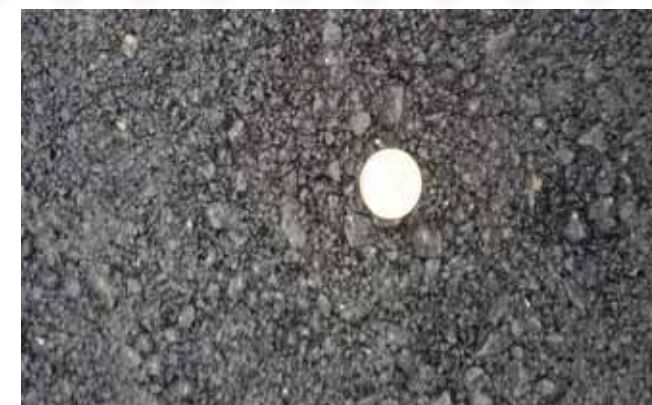
ACF22: 100% RAP + 4,5% REJUVENÁTOR a bitumenre vonatkoztatva
