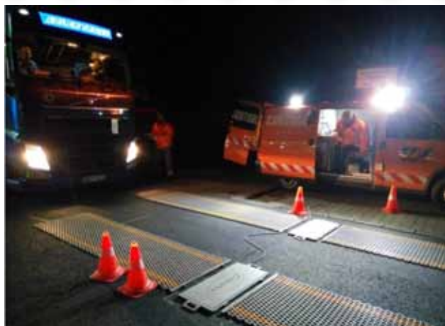
11. kép: A mérőállomás rendszeres, szűrőpróba szerű mérése az ország területén bárho
