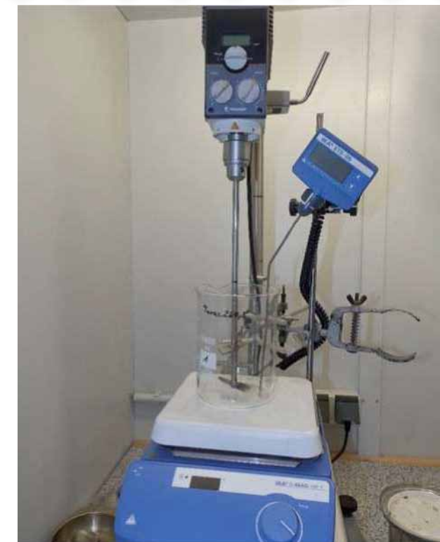
3. ábra: Lapátos keverő a rejuvenátor keveredéséhez
