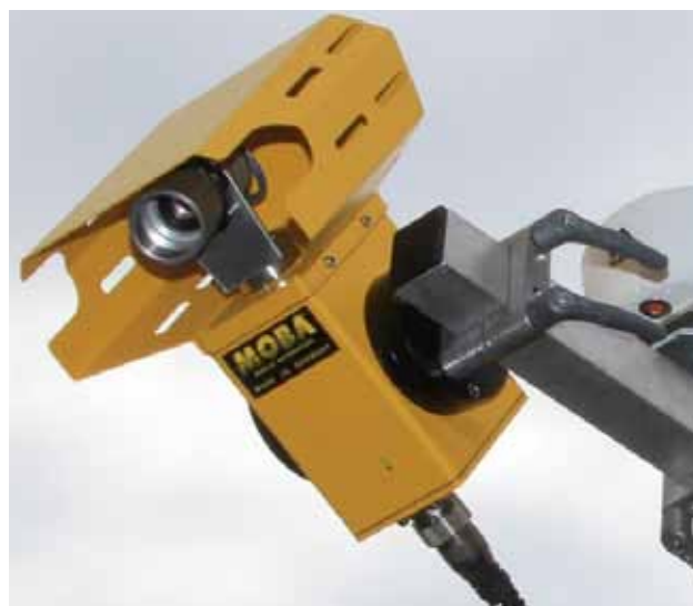
6. kép: Infravörös szkennerek az aszfalt felületi hőmérsékletének mérésére
