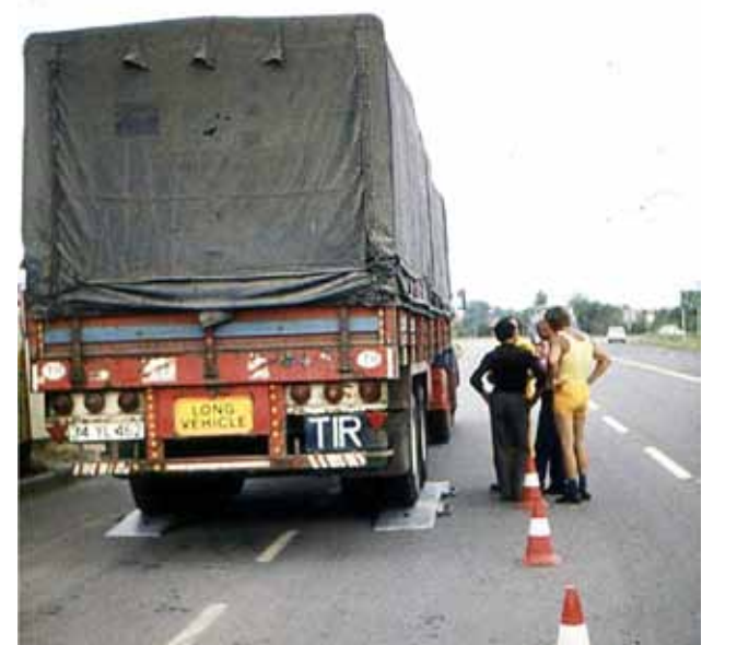
9-10. kép: Tengelyterhelés mérés Békés megyében. 1970-es évek végén. A mérés lassúsága miatt nem terjedt el.
