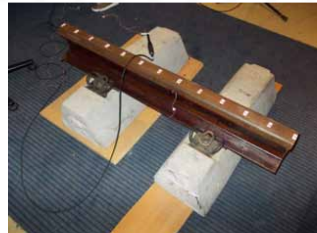
2. ábra: Mérési rendszer, csillapítatlan sinszál (referencia)
