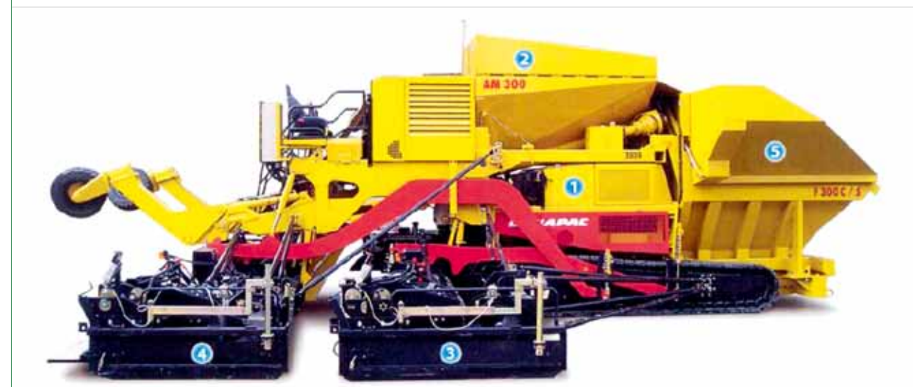
6. ábra A kompaktaszfalt finisher sematikus ábrája [1.]
