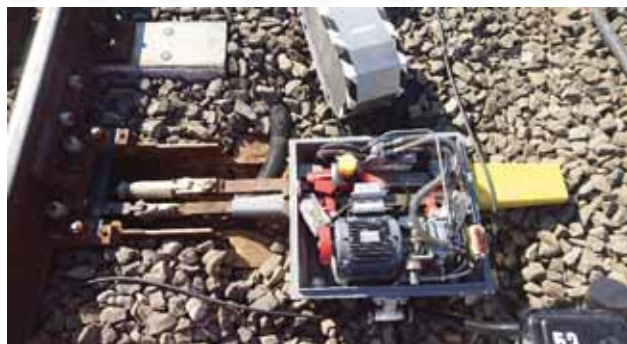
4. kép Hidraulikus elven működő váltóállító készülék
