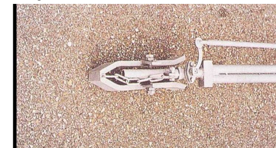
12. ábra: Bedolgozás széles papucsos fejjel [saját kép]
