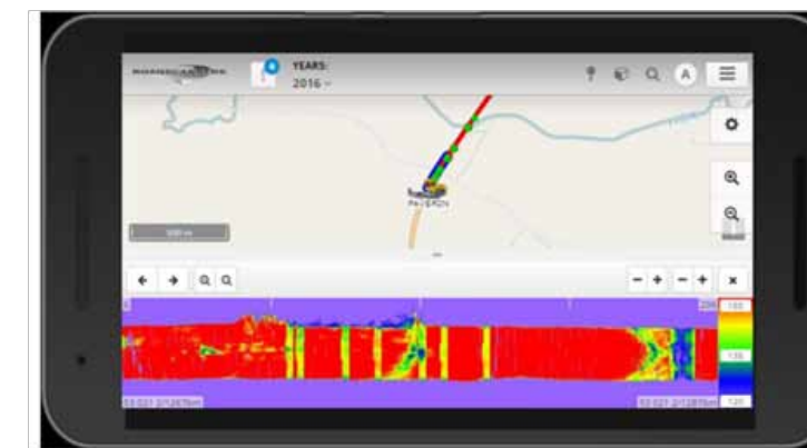
Az aszfalt hőmérsékletének kijelzése mobil eszközön
