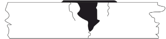
SZÉLES REPEDÉS JAVÍTÁSA FORRÓLEVEGŐS TISZTÍTÁSSAL ÉS PAPUCSOS FEJES KITÖLTÉSSSEL
