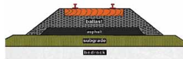
12.ábra: „Asphalt Underlayment” - Vasúti pályaalap a szemcsés alsó zuzalékágy réteg nélkül
